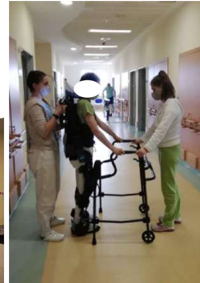
Járás szabad felületen, testen viselhető exoskeleton robottal
