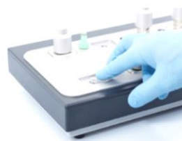
Helyezzük tesztcellát a tesztcella csatornába
