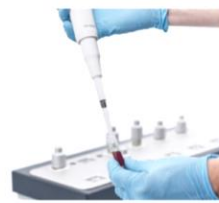
Helyezzük fel az aktív-pipettahegyet a pipettára és szívunk fel 330 µl citrátos teljes vért
