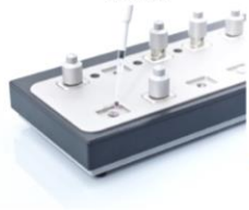
Szívjuk fel, majd töltjük vissza a mintát a tesztcellába még egyszer – hatékonyabb keverés miatt
