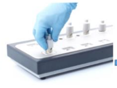
Tekerje a tesztcella fedő tartót balra, hogy kiadja a zárt tesztcellát
