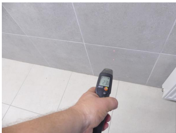
A pincefalak felületi hőmérséklete: 23,0 C° (a kapilláris kondenzációs és harmatponti hőmérséklet alatt)
