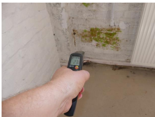
A pincefalak felületi hőmérséklete: 23,0 C°; 21,0 C° (a kapilláris kondenzációs és harmatponti hőmérséklet alatt)
