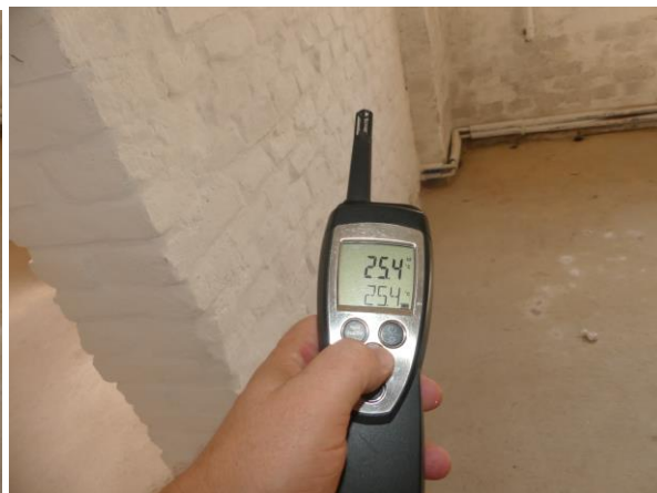
A belső levegő relatív páratartalma 99,9 %, a léghőmérséklet 25,4 C°, a harmatpont 25,4 C°, nedves hőmérséklet 25,4 C°.
