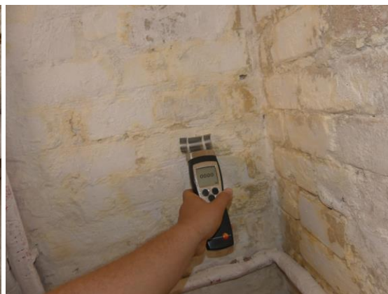
Külső földpartos falak nedvességtartalma 20 m% felett a kerékpártárolóban
