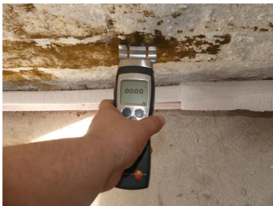
Külső földpartos falak nedvességtartalma 20 m% felett a kerékpártárolóban
