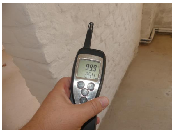
A belső levegő relatív páratartalma 99,9 %, a léghőmérséklet 25,4 C°, a harmatpont 25,4 C°, nedves hőmérséklet 25,4 C°.
