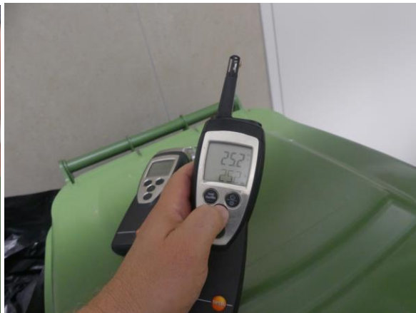
A belső levegő relatív páratartalma 99,9 %, a léghőmérséklet 25,2 C°, a harmatpont 25,2 C°, nedves hőmérséklet 25,2 C°.
