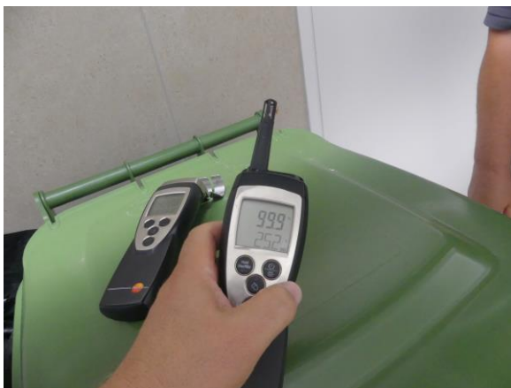
A belső levegő relatív páratartalma 99,9 %, a léghőmérséklet 25,2 C°, a harmatpont 25,2 C°, nedves hőmérséklet 25,2 C°.
