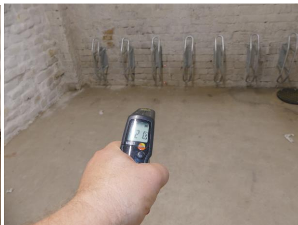
A pincefalak felületi hőmérséklete: 23,0 C°; 21,0 C° (a kapilláris kondenzációs és harmatponti hőmérséklet alatt)
